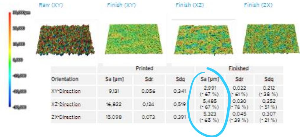
Beispielwerte für die Veränderung der Rauheit von SAF™ PP durch VaporFuse Surfacing mit dem Programm SAF™ PP - Balanced sind für drei verschiedene Oberflächen angegeben. Die Messungen der Oberflächenrauheit wurden mit einem 3D-Profilometer VR-3200 gemäß EN ISO 25178 durchgeführt.
